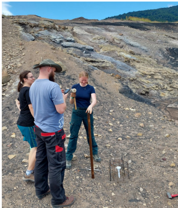
Umístění čidel a měřicích zařízení pro výzkum využití post-těžebních lokalit.
